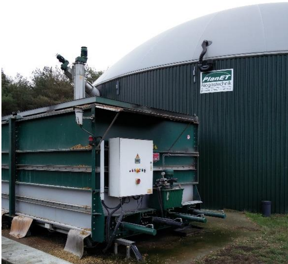
Abbildung 15-63: Feststoffdosierer und Fermenter der BGA 15
